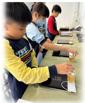
學生利用平板電腦測光感應器量度濾液的透光度
